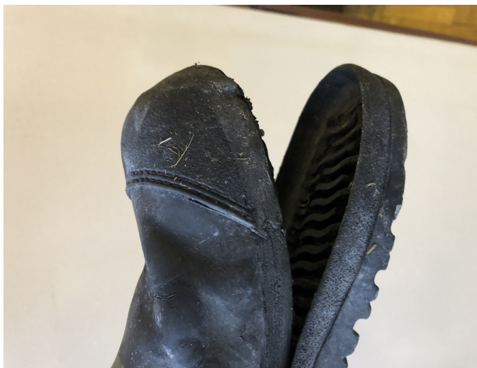
4. kép Káreset közben történt csizmatalp leválás
